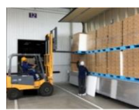
「標準仕様パレット」の利用による荷役時間の短縮
